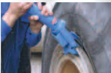
Destalonador manual para llantas de camión
